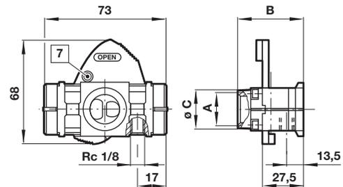
7 Bohrung für Vorhängeschloss ø7,5 mm
