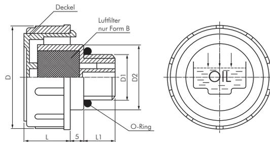
**3.2. Einfüll- und Belüftungsschrauben aus Kunststoff ohne Luftfilter**
