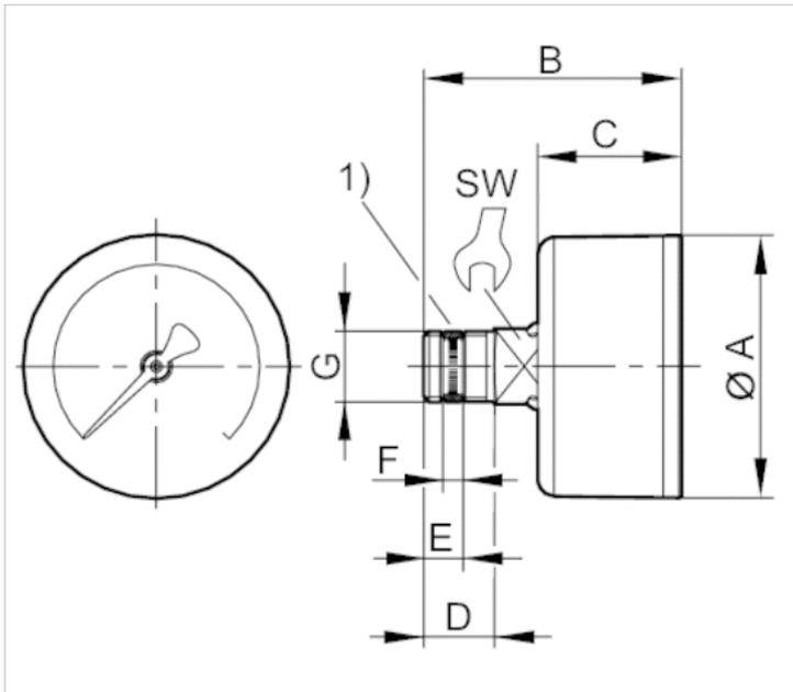
1) montierte Dichtung
