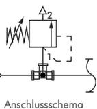
**Achtung:** Dieses Ventil ersetzt trotz ähnlicher Funktion kein Sicherheitsventil und ist auch nicht als Druckregler einsetzbar!
