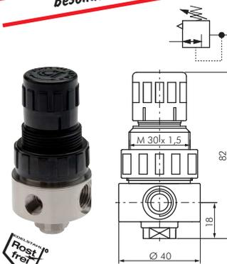
**Durchfluss:** Kv-Wert 0,35 m<sup>3</sup>/h, 330 l/min<sup>1)</sup>
