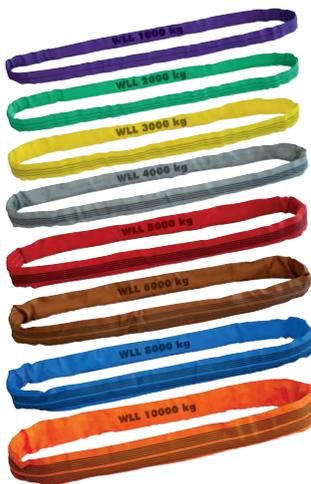
**Ausführung:** Nach DIN EN 1492-2 gefertigte, UV-beständige Rundschlingen mit farbcodiertem Einfachmantel, eingewebten Tonnenstreifen und Tragfähigkeitsaufdruck, Sicherheitsfaktor (SF) 7:1. Keine Feuchtigkeitsaufnahme in den Gurtfasern, daher keine Frostgefahr und weitgehende Verrottungsbeständigkeit.
